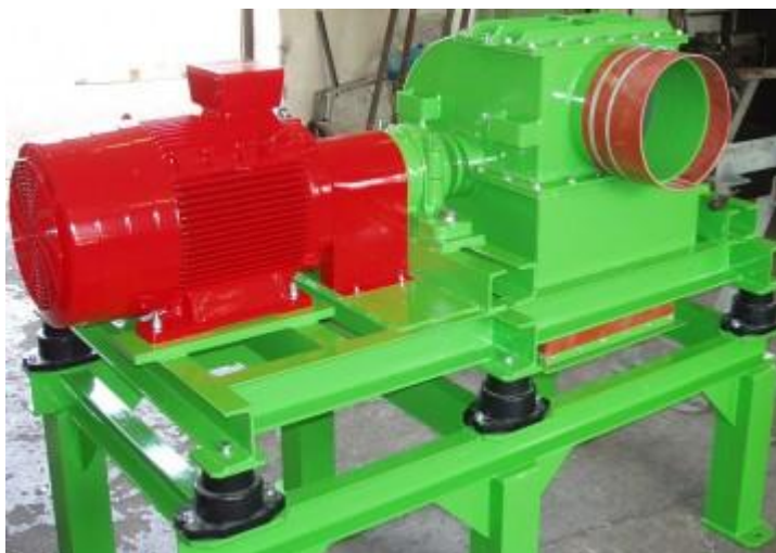
Obrázek 6.7: Horizontální šrotovník Taurus HM 22
