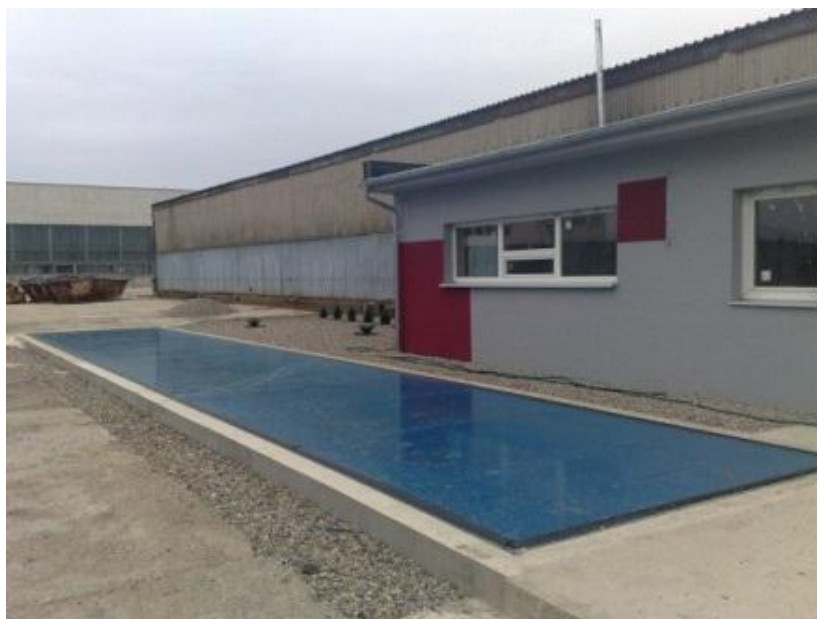
Obrázek 6.2: Stabilní váha MAV – OS – 3x9/30
