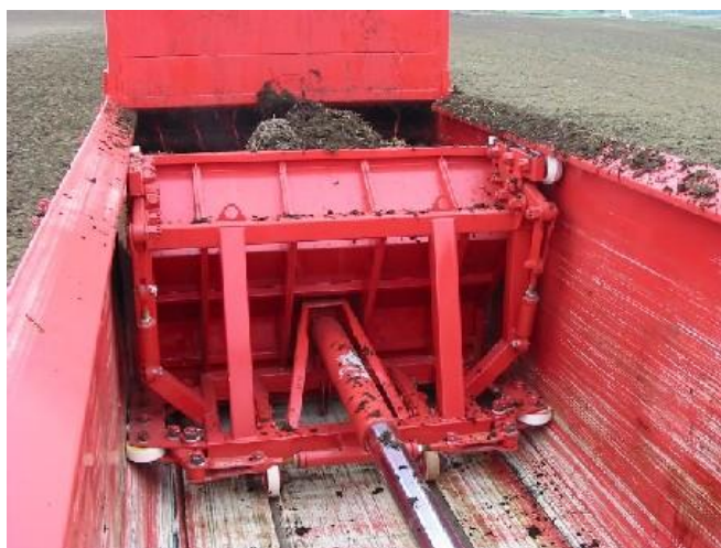
Obrázek č. 5.3. - Detail výtlačného čela Annaburger HTS Schubfix 22.18 (10)
