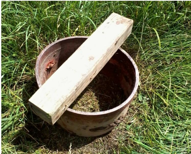
Obr. č. 13 Zatloukání válce pomocí dřevěného trámku (vlastní foto)
