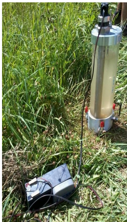
Obr. č.16 Kompaktní infiltrometr a datalogger připojený k baterii (vlastní foto)
