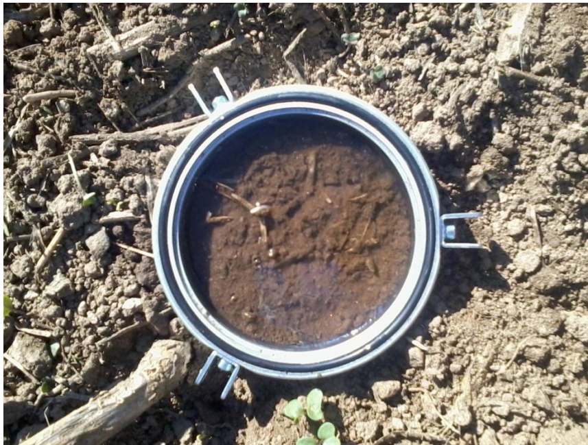
Příloha 5: Ocelový prstenec kompaktního infiltrometru zaražený do povrchu
