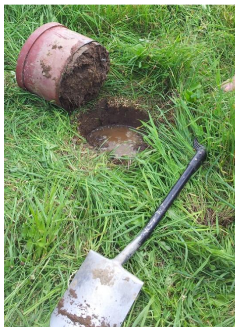
Obr. č. 15 Vyjmutí válce z povrchu (vlastní foto)
