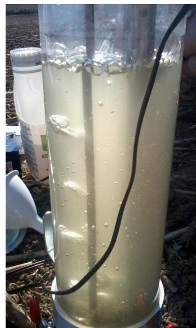
Obr. č. 20 Zaplnění prostoru pod infiltrometrem (vlastní foto)
