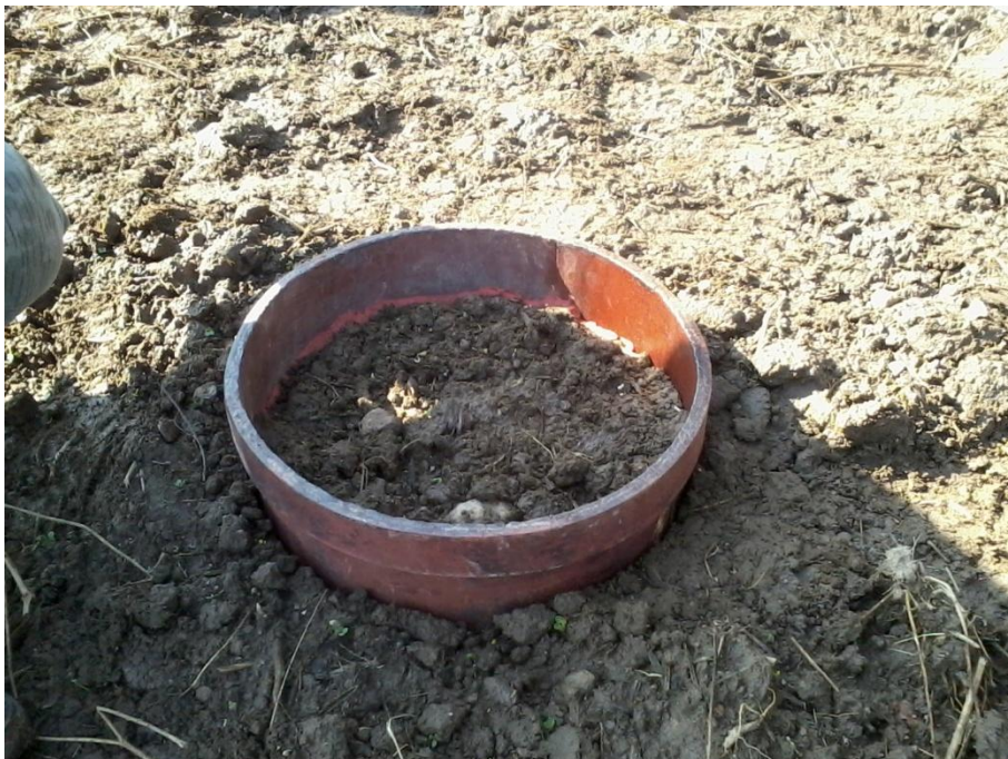
Příloha 2: Zaražený infiltrometr do povrchu půdy
