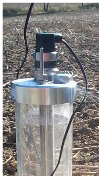
Obr. č. 17 Montáž kapacitního čidla (vlastní foto)
