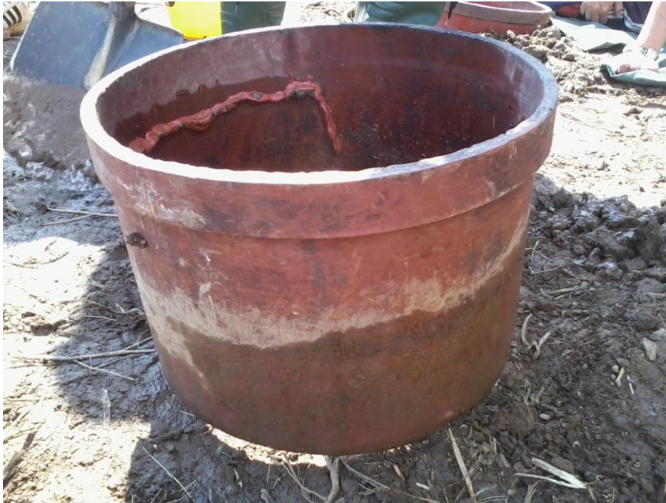
Příloha 1: Jednoválcový infiltrometr s plastelínou pro utěsnění
