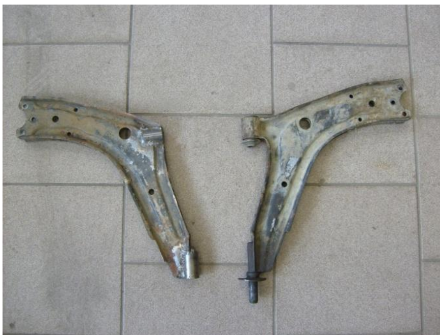
Obrázek 42 – Porovnání sériového a upraveného ramena [33]
