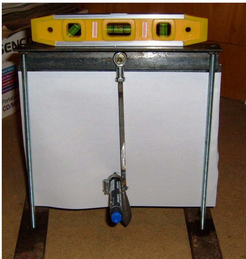
Obrázek 52 - Kyvadlové měřidlo bočního náklonu [37]
