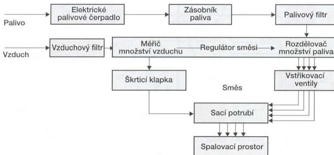
Obrázek 8 Princip mechanického vstřikování
