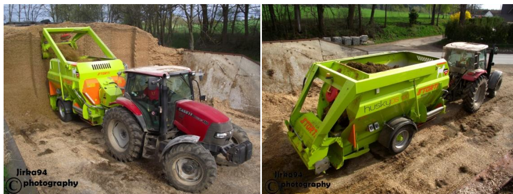
Obr. 8 Princip vybírání siláží ze žlabu.
