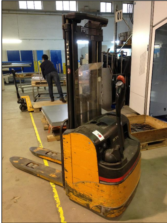
Obrázek 27 - Vysokozdvížený, elektrický, ručně vedený vozík.
