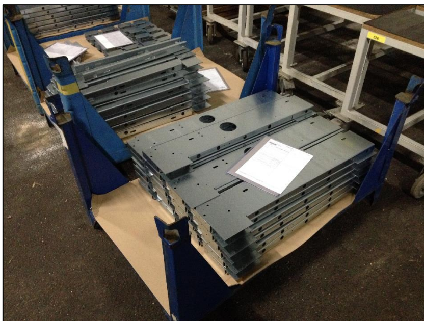
Obrázek 31 - Ocelová klec bez bočnic určená ke stohování.
