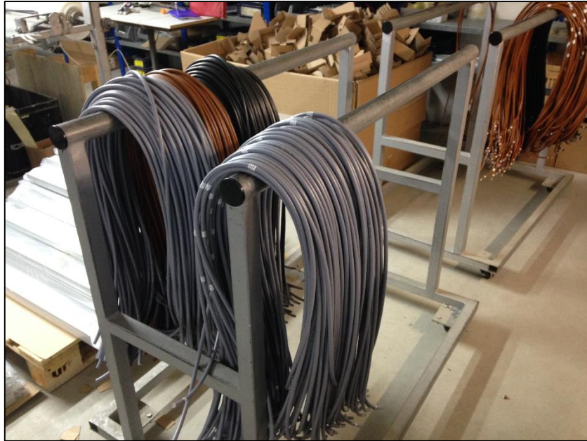
Obrázek 39 - Trubkový stojan na kabely.
