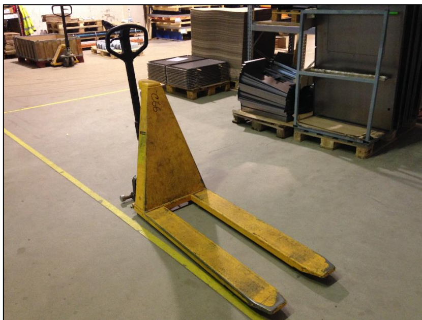
Obrázek 24 - Paletový vozík s vyšším zdvihem a max. nosností 1000kg.
