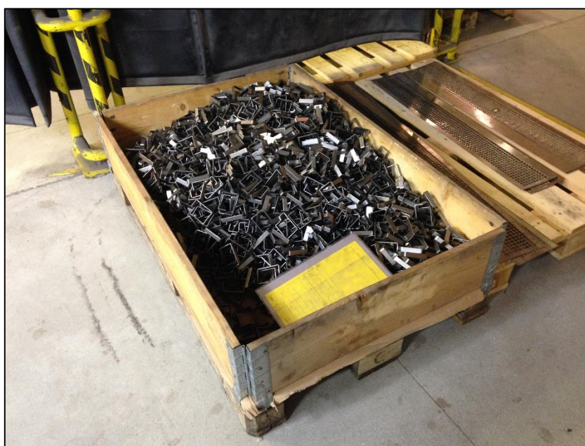
Obrázek 34 - Paletová ohrádka pro drobné výrobky v mezioperačním skladu.
