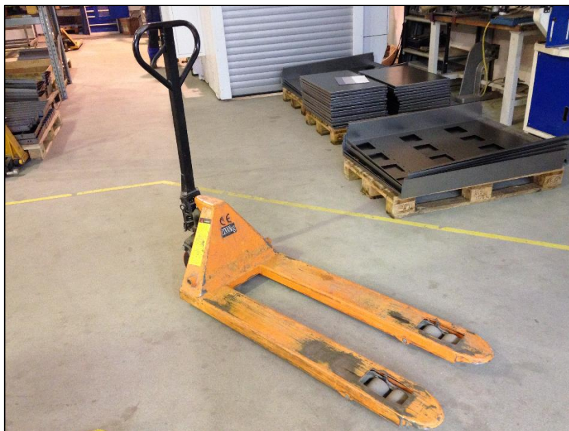
Obrázek 23 - Nejpoužívanější paletový vozík s max. nosností 2200kg.
