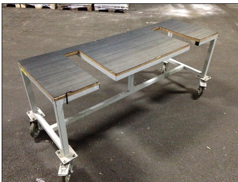
Obrázek 38 - Speciální vozík pro elektro rozvaděče. Slouží i jako montážní stůl.
