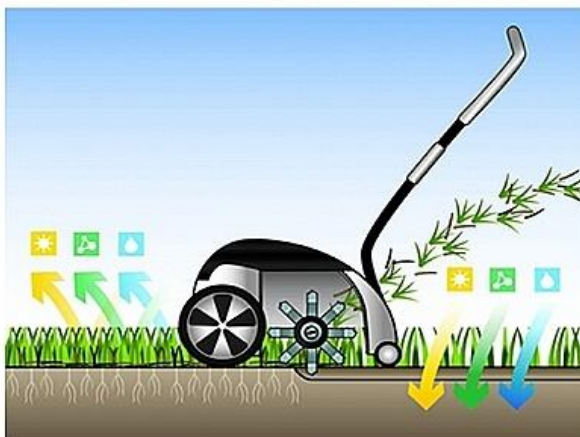
Obrázek 3 - Schéma prořezávání trávníku ( http://www.toolscomp.cz/soubory-ve-skladu/Technologie/Provzdušnovace_a_vertikutatory/SEK715_al_ko_38_vlb_combi_care_comfort_aeri_scarifi.jpg , 16.11. 2014)
