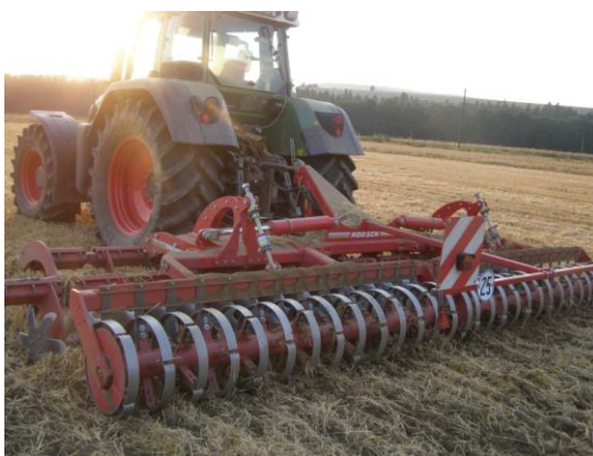
Obr. č. 8: Diskový podmítač Horsch Joker 6
