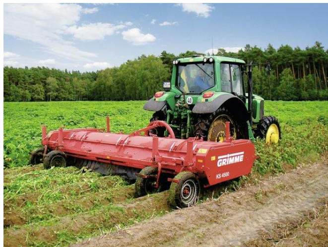
Obr. č. 18: Rozbíječ natě Grimme Krautschlager KS 4500 Zdroj: www.grimme.com , „staženo dne 25. 3. 2014“
