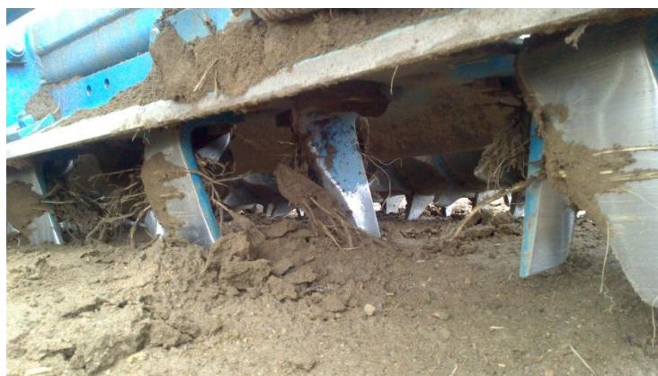
Obr. č. 36: Hřeby rotačního kypřiče
