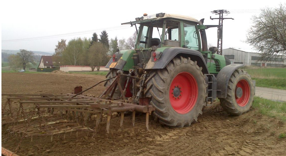
Obr. č. 34: Fendt 920 s hlubkovým kypříčem
