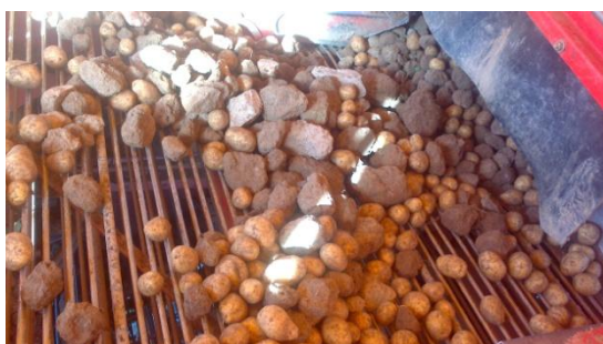
Obr. č. 53: Přebírací stůl sklízeče Grimme SE 150-60
