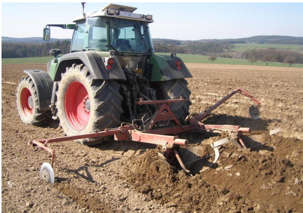
Obr. č. 11: Dvouradličný rýhovač Scan Stone
