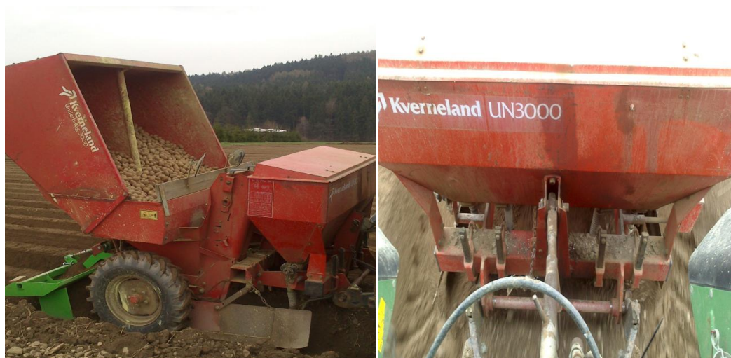
Obr. č. 5 a Obr. č. 6: Sazeč brambor s aplikací tuhých minerálních hnojiv
