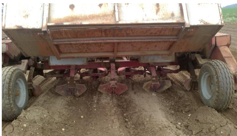
Obr. č. 38: zahrnovací radličky sazeče MARS – 41, SA 2-070
