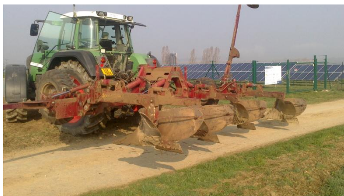
Obr. č. 27: Rýhovací stroj ScantStone nesený traktorem Fendt 920
