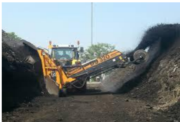
Obr. č. 4: Překopávání Kompostu
