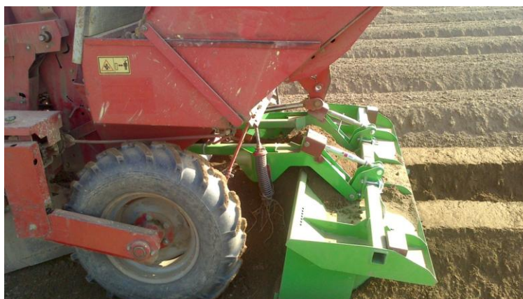
Obr. č. 15: Sazeč brambor s formátovačem brázd
