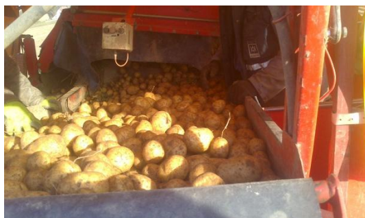
Obr. č. 47: Přebírací stůl sklízecí Grimme SE 150-60
