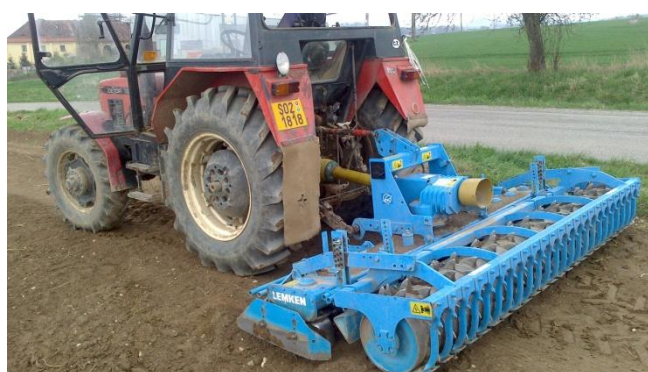
Obr. č. 35: Rotační kypřič Lemken Zirkon
