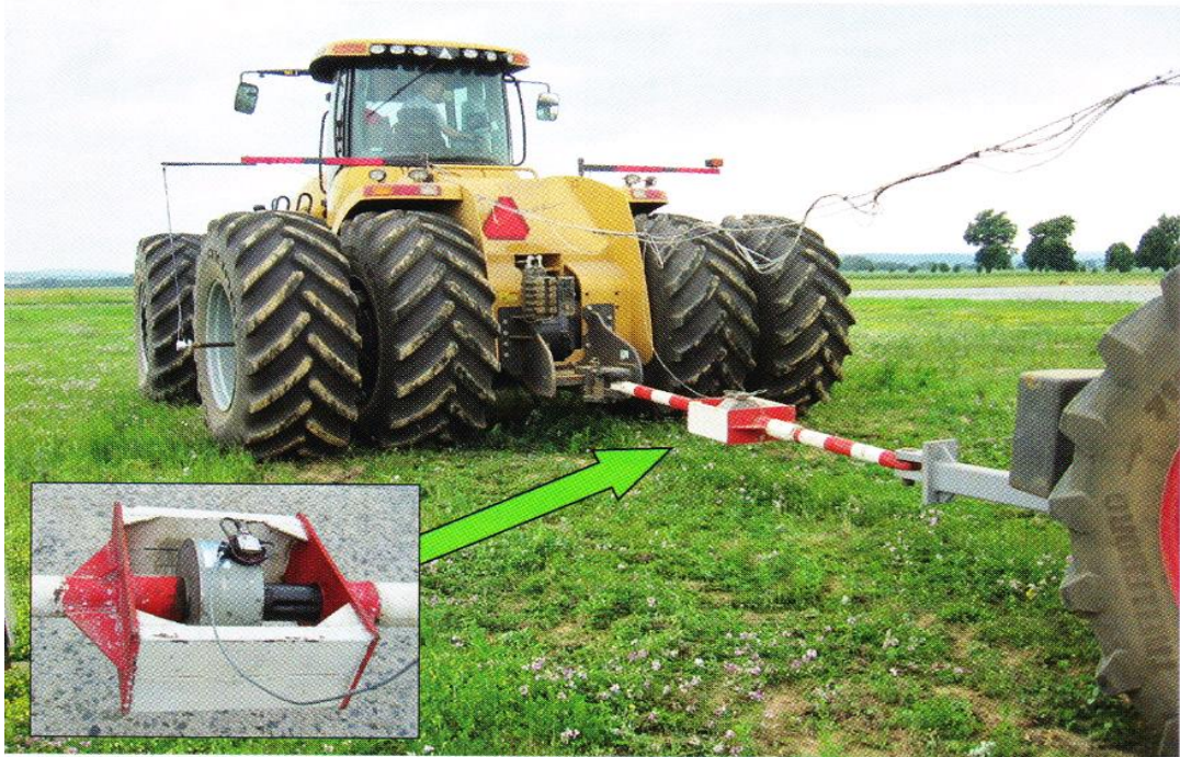
Obrázek 2.1 Měření tahové charakteristiky traktoru na pozemku
