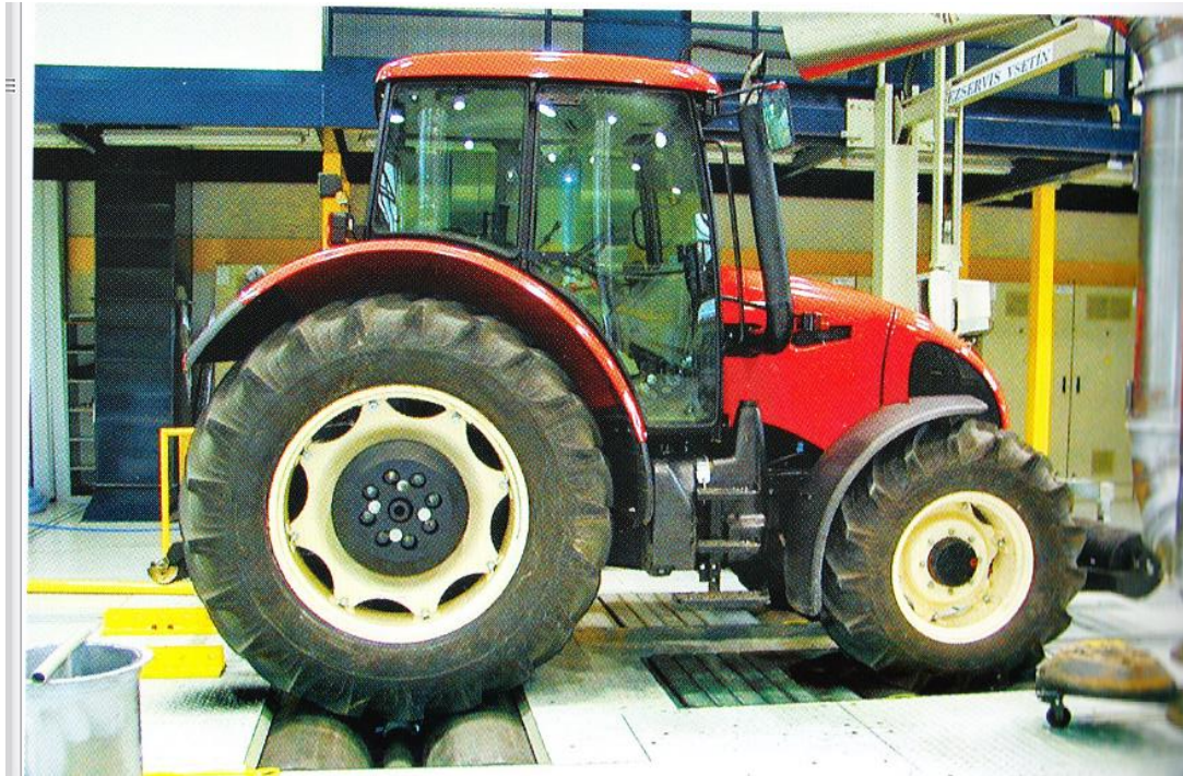
Obrázek 2.6 Traktor Zetor na válcovém dynamometru v laboratoři MENDELU v Brně
