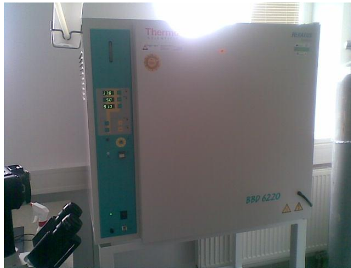
Foto č. 3 BBD 6220 CO 2 Incubator - teplotní vědecký CO 2 inkubátor (termostat), aktivní zvlhčování kontroly a integrální vysoké teploty sterilizačního cyklu
