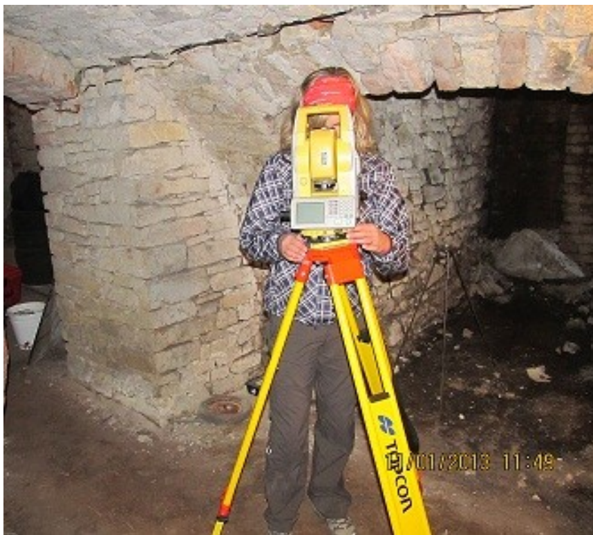
Obr. 7.1 Měření podzemních prostor polygonovým pořadem
