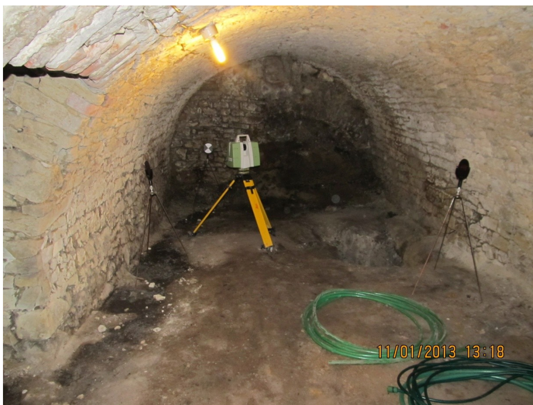
Obr. 7.3 Podzemní laserové skenování
