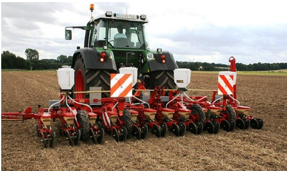
Obrázek 25: Přesný secí stroj pro výsev obalovaného kalibrovaného osiva cukrové řepy
