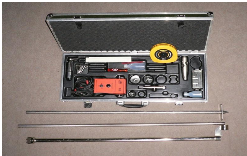
Obrázek 18 Sestava hydrometrické vrtule OTT-C2 (foto: Vácha, 2014)
