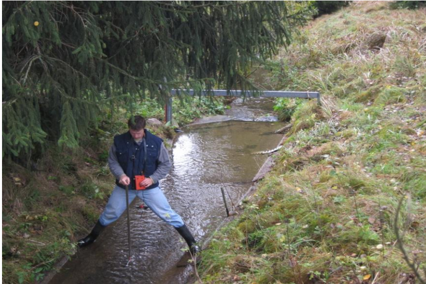
Obrázek 19 Měření průtoku hydrometrickou vrtulí (foto: Procházka, 2012)
