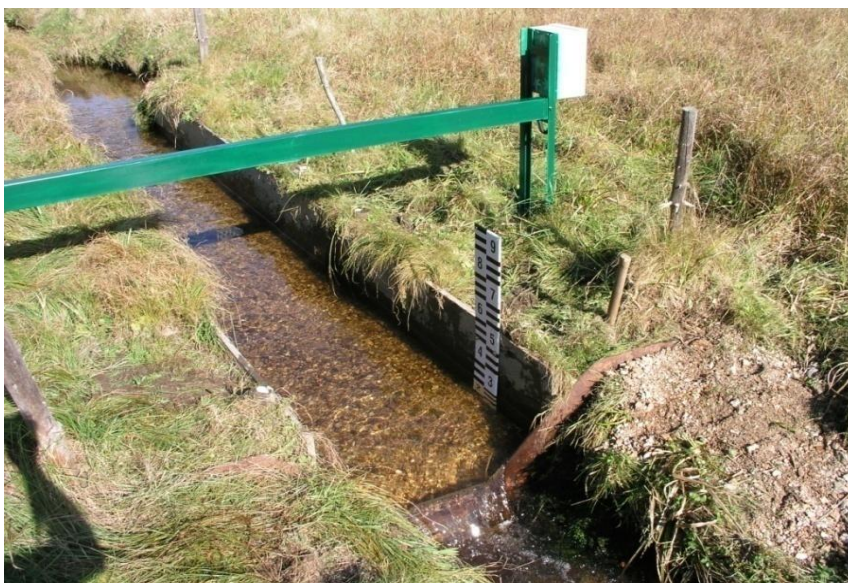
Obrázek 17 Závěrný profil povodí Bukového potoka s automatickým měřením výšky hladiny (ultrazvuk), vodivosti a teploty vody (foto: Procházka, 2010)
