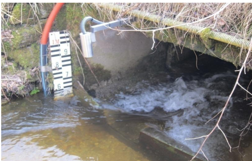
Obrázek 15 Závěrný profil povodí Horského potoka s automatickým měřením výšky hladiny (ultrazvuk), vodivosti a teploty vody. (foto: Procházka, 2012)
