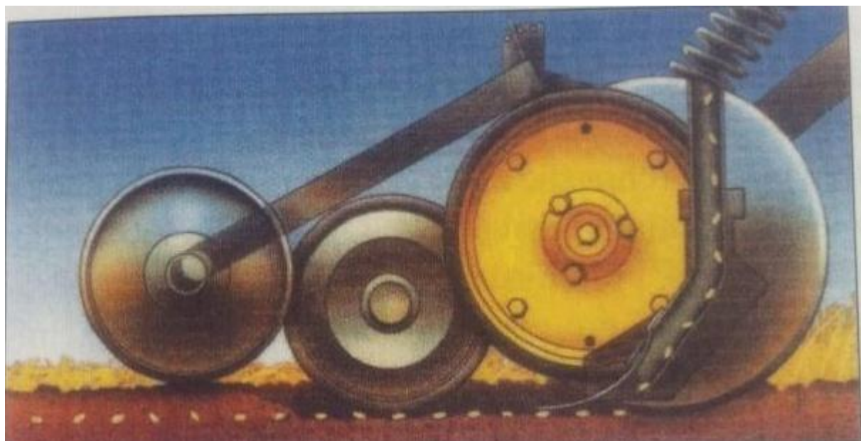
Obr. 12: Kotoučová secí botka vhodná pro setí do minimálně zpracované nebo do nezpracované půdy, (Hůla a kol., 2003).
