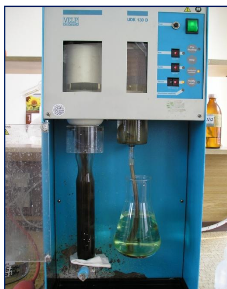
Příloha č. 21: UDK 130 D 442, destilační přístroj na stanovení obsahu N-látek podle Kjeldahla, výrobce: VELP Scientifica s.r.l., autor fotografie: Dupalová Šárka, 17. 7. 2013, laboratoř ZS Dynín, a.s.
