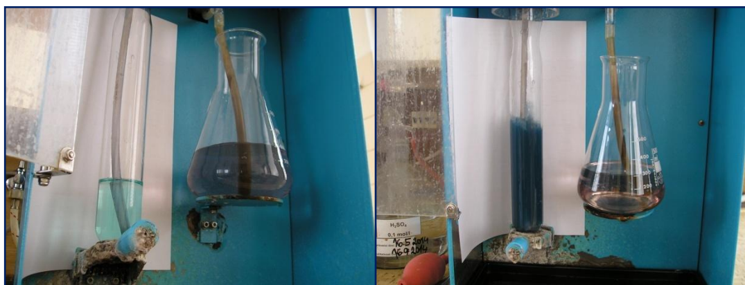
Příloha č. 19 a 20: UDK 130 D 442, destilační přístroj na stanovení obsahu N-látek podle Kjeldahla, výrobce: VELP Scientifica s.r.l., autor fotografie: Dupalová Šárka, 17. 7. 2013, laboratoř ZS Dynín, a.s.
