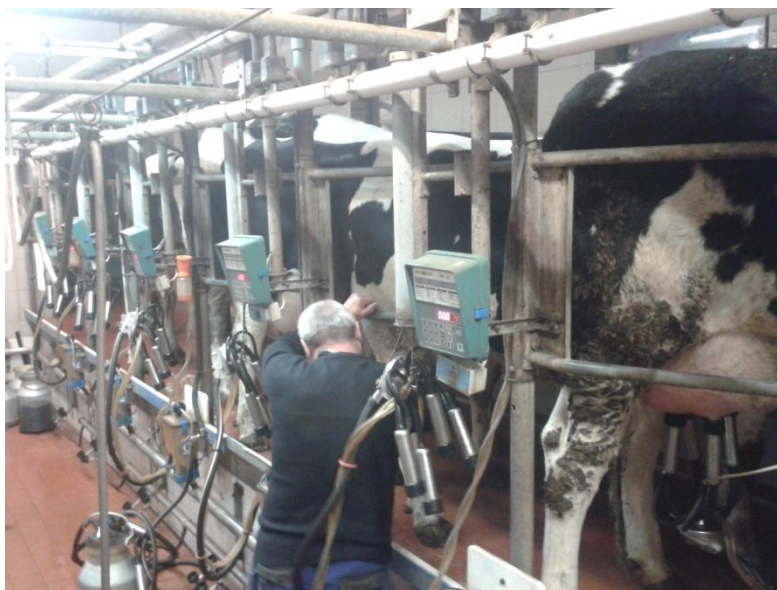
Obrázek 15 Dojení do potrubí, Rybínová dojírna, Foto: Jan Mondek
