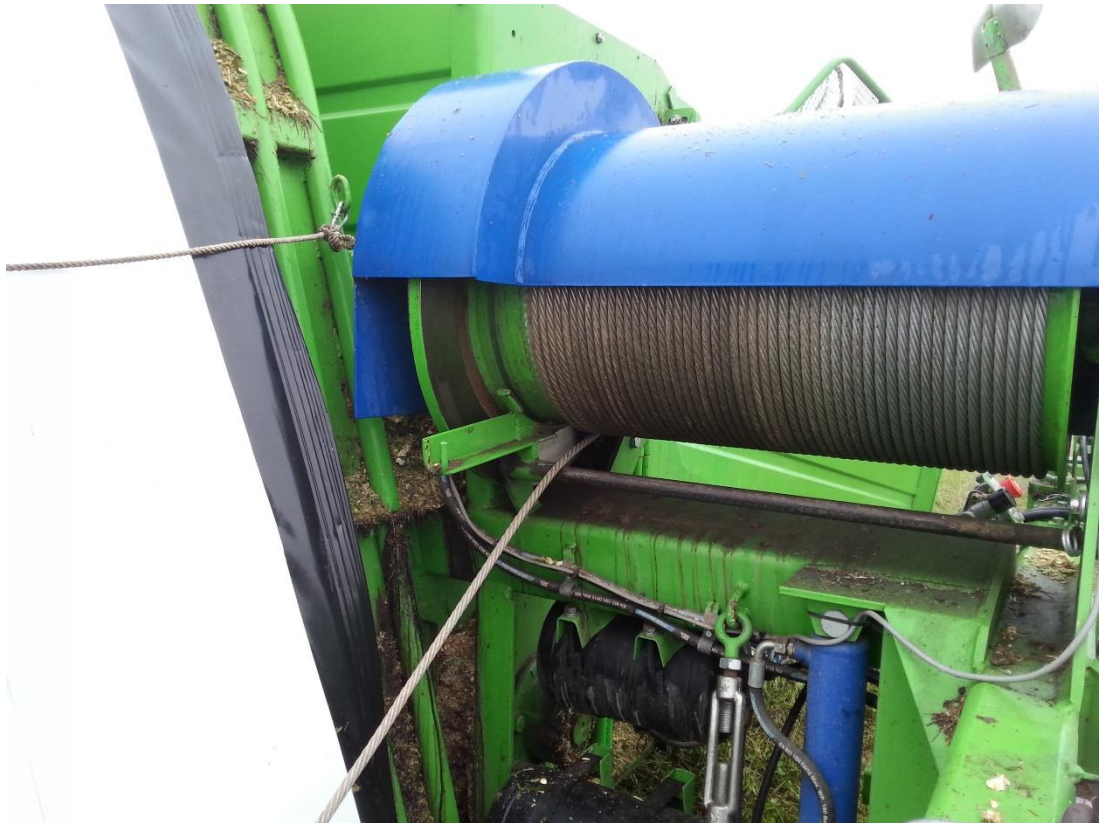
Obrázek 2.7 - Kotoučová brzda navijecího bubnu Budissa Bag
