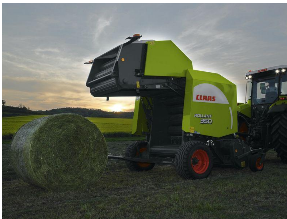
Obrázek 2.9 – svinovací lis s pevnou komorou CLAAS ROLLANT 350 [23]
