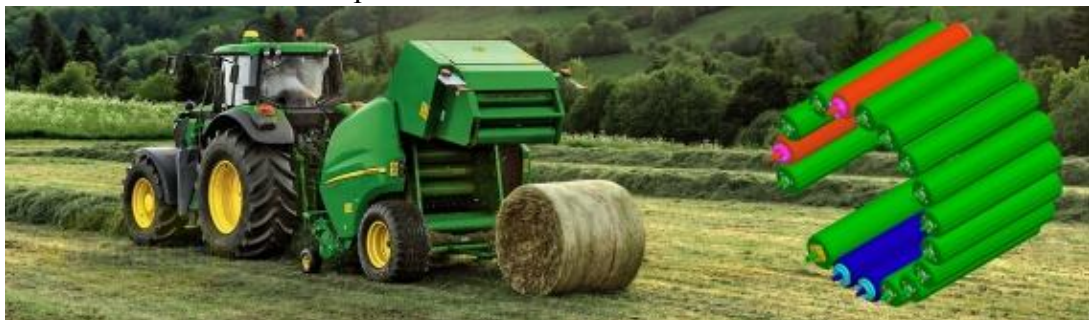
Obrázek 2.3 - svinovací lis JOHN DEERE F440R s konstantní (pevnou) lisovací komorou [18]
