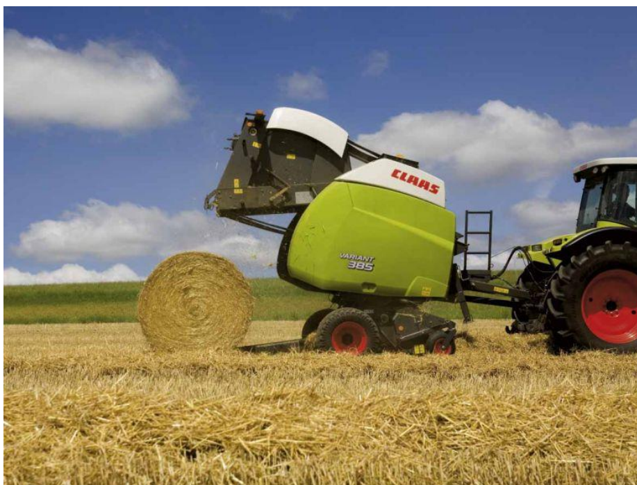
Obrázek 2.8 – svinovací lis s variabilní komorou CLAAS VARIANT 385 [22]
