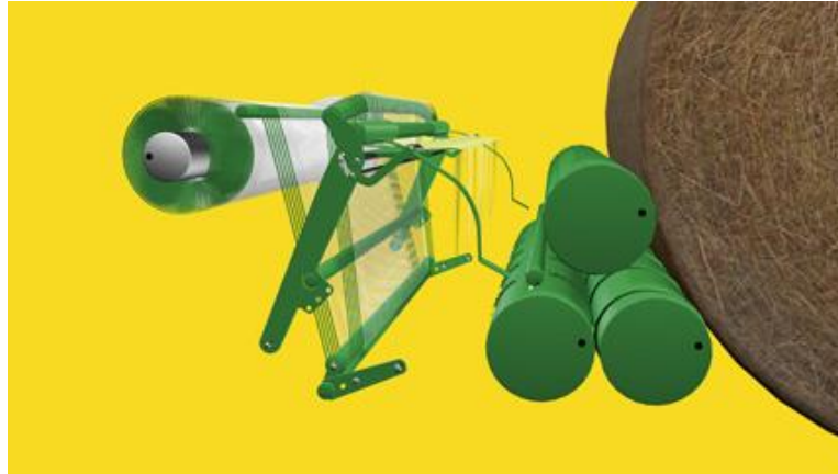
Obr. 2.10 - vázání do sítě - poloha na začátku vázání [24]
