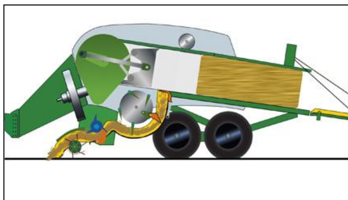
Obrázek 2.16 - lisování hranolovitého balíku – sběr a přechování materiálu [25]
