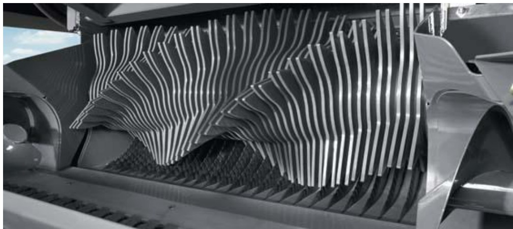
Obrázek 2.6 – vkládací ústrojí CLAAS ROLLANT 455 uniwrap [20]
