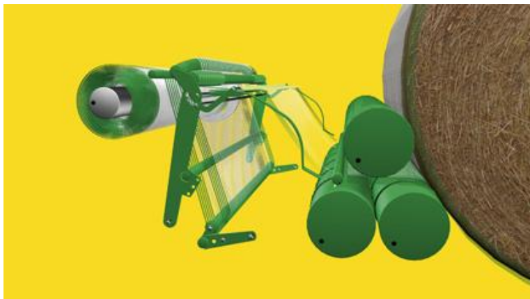
Obr. 2.13 - vázání do sítě – poloha při odříznutí [24]
