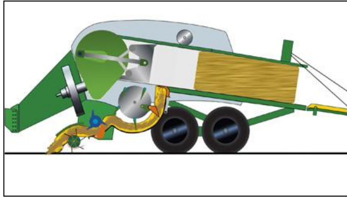
Obrázek 2.17 - lisování hranolovitého balíku – přechování materiálu [25]
