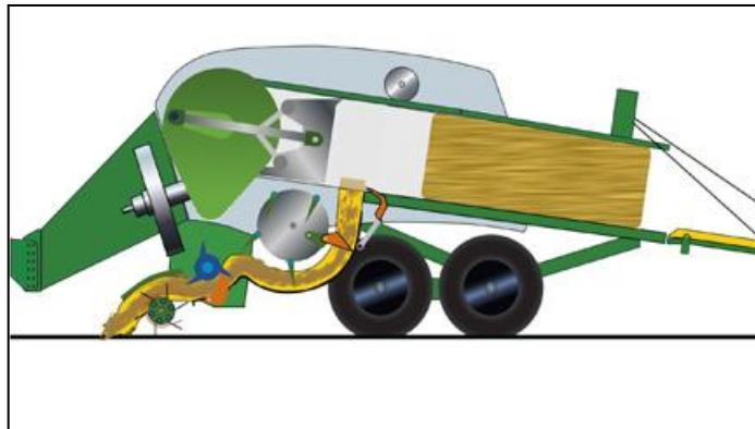
Obrázek 2.18 - lisování hranolovitého balíku – posun materiálu do lis. Kanálu [25]
