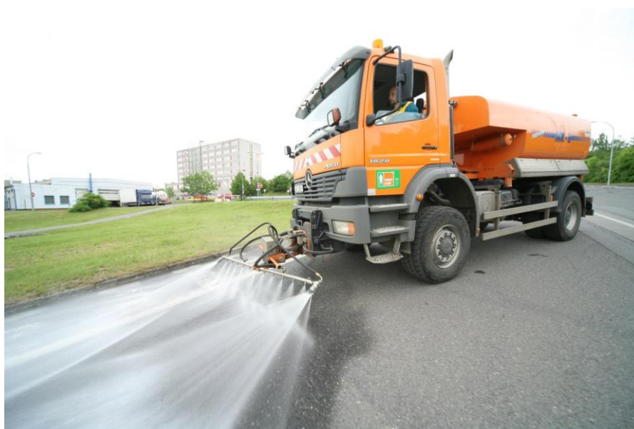
Obrázek 12 - Nákladní automobil s nástavbou a zařízením pro čištění komunikací
