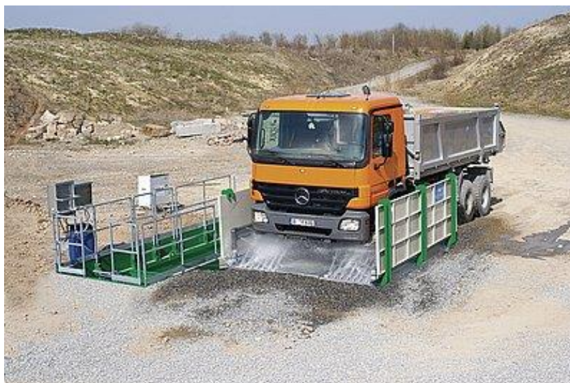
Obrázek 11 - Mycí rampy podvozků a kol pro automobily
