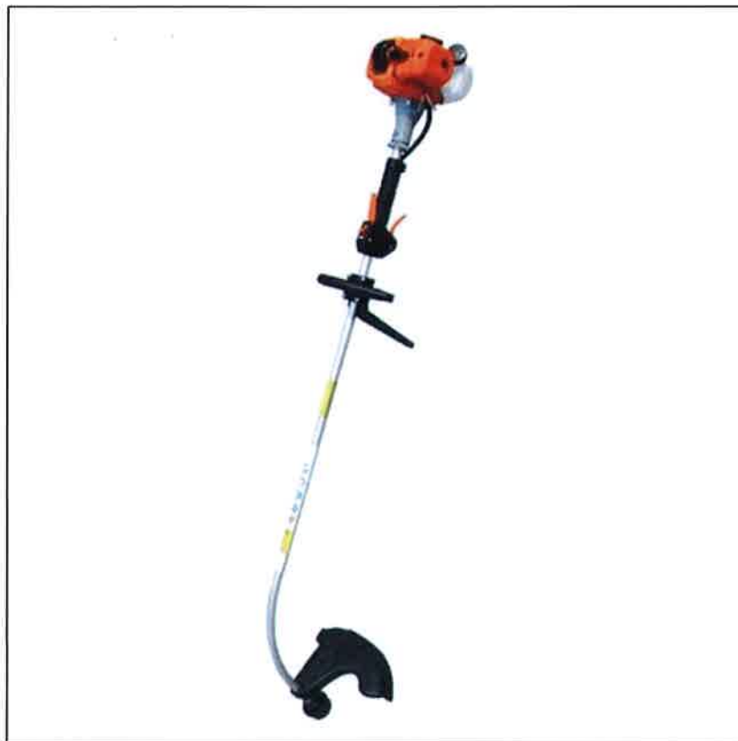
Obrázek 10 – Zahradní žací nesený strunový vyžínač
