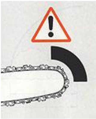
Obrázek 3 zpětný ráz Zdroj [17]
