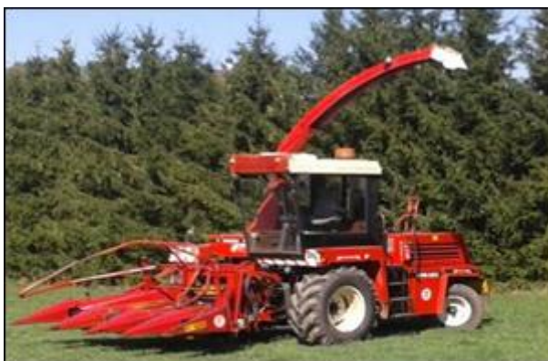
Obrázek 3 Samojízdná sklízecí řezačka SP 8-050 vyráběná v Agrostroji Prostějov
