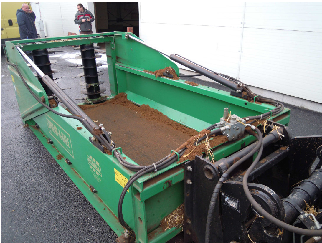
Obr. 4 Řezací a rozmetací zařízení sloužící k podestýlání a to jak rašeliny tak slámy (foto: autor)
