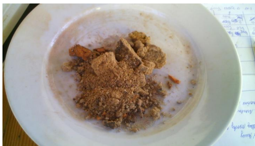
Obr. č. 1: Vzorek zdiva 100g, připravený na vysušení
