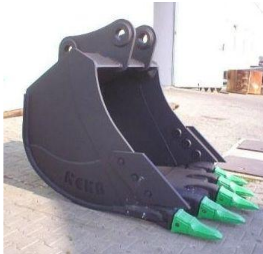
Obrázek 2. 2. 2 – Nakládací zubová lopata s šípovým břitem
