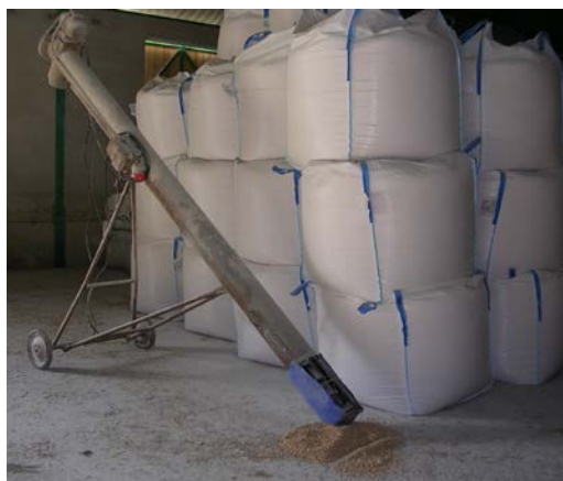
Foto 13 - Šnekový mobilní dopravník, velkoobjemové vaky (uskladnění) [Šafránková]
