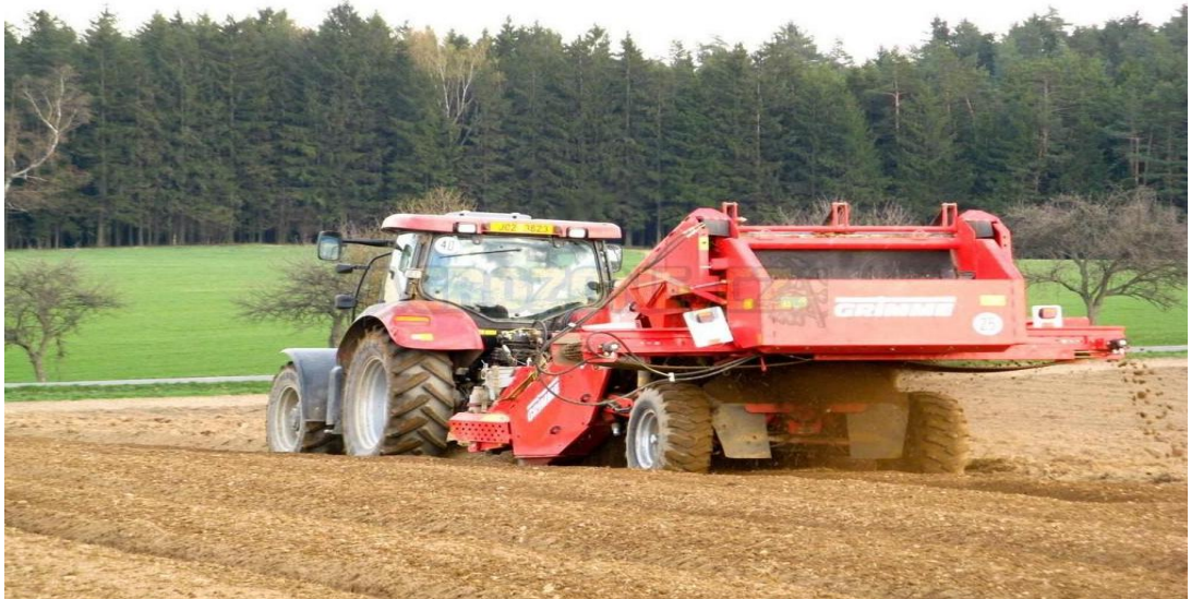
Obr. č. 6 Průběh odkameňování pomocí odkameňovače (www.agrozone.cz).
