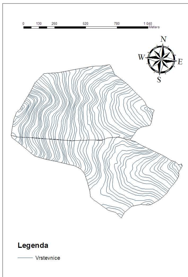
Obr.12.: Vrstevnicový model subpovodí Jenínského potoka J1 (dole) a J2 (nahore)
