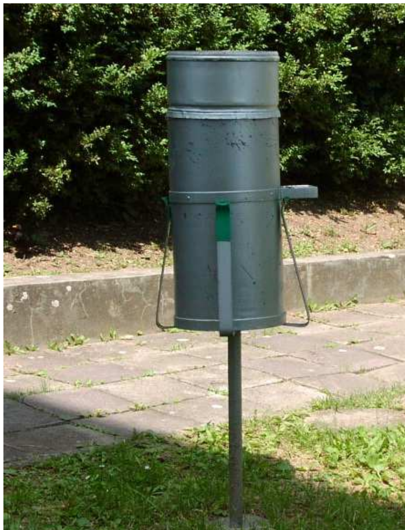
Obr. č. 4-2: Manuální srážkoměr s lidskou obsluhou
