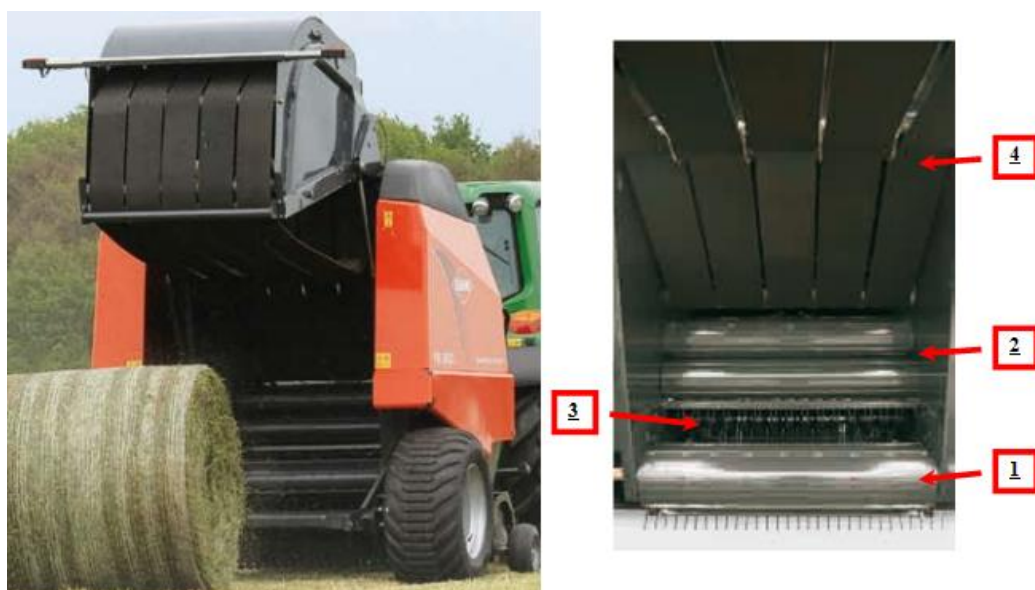
Obrázek 6 Lisovací komora , spodní hnací válec (1), dva horní hnací válce (2), řezací ústrojí (3), lisovací pásy (4), Foto: Vojtěch Kočí 16. 7. 2013
