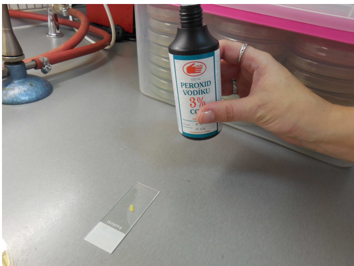
Obr.č. 10 Peroxidový test na potvrzení výskytu P. larvae
