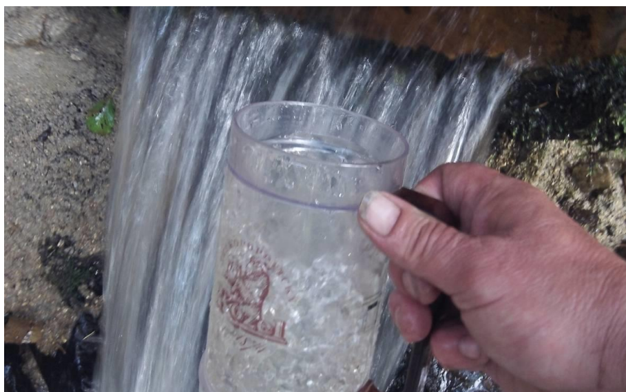
Obr. č. 65 – Odhad vydatnosti přítoku č.3 – silniční propustek - AUTOR PRÁCE 2013
