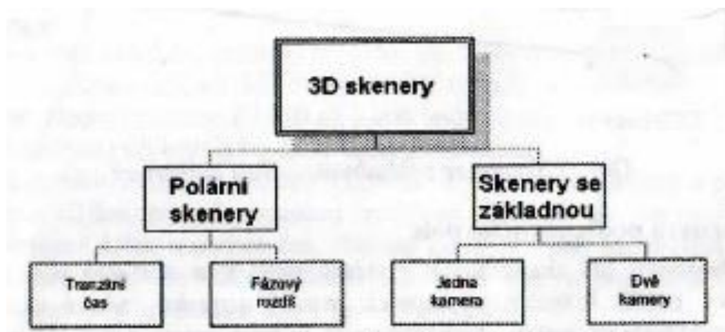
(Obr. č. 15 Rozdělení skenerů podle měřicího principu; POSPÍŠIL, 2007)
