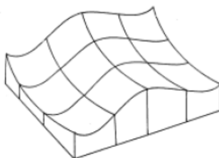
(Obr. č. 12 Deformace filmu v rovině snímku; HANZL, 2006)
