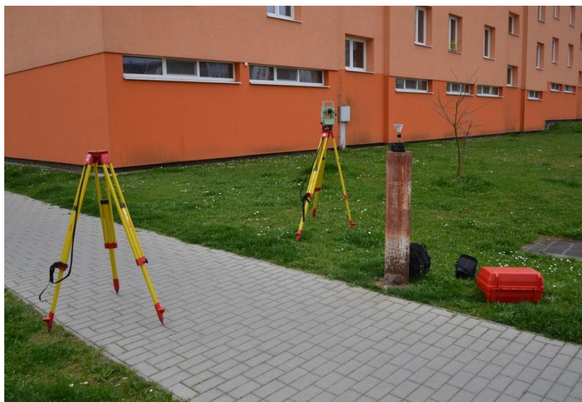
Obr. 8: Postup ověřování svislosti montáže [Zdroj: Vlastní foto]
