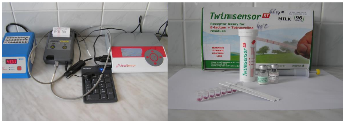
Obrázek 4. Twinsensor BT s příslušenstvím - inkubační jednotka (vlevo), tiskárna s klávesnicí, ReadSensor
