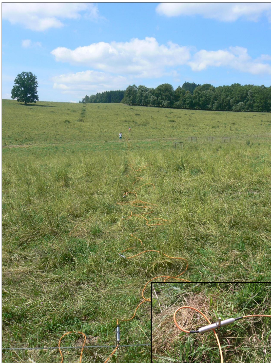
Foto 1 Celkový pohled na proměřovaný transekt T3a s detailem uzemněné nerezové elektrody.
