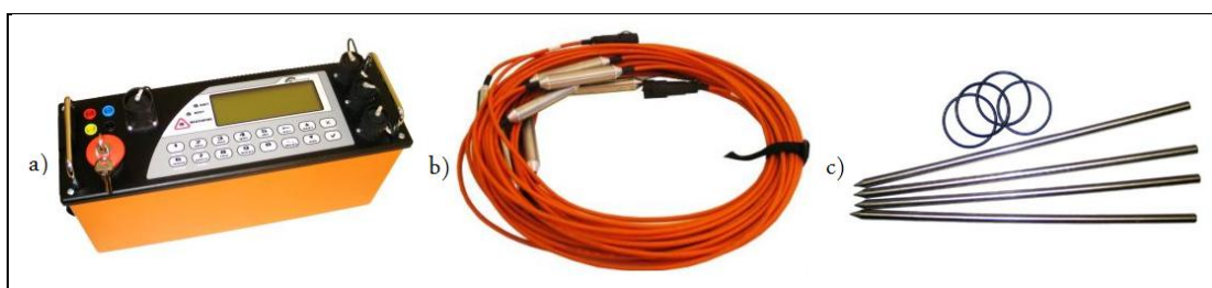
Obr. 10 Základní přístrojové vybavení. (a) řídicí jednotka ARES; b) aktivní multielektrodový kabel; c) nerezové elektrody. Zdroj: ( GF INSTRUMENTS ).
