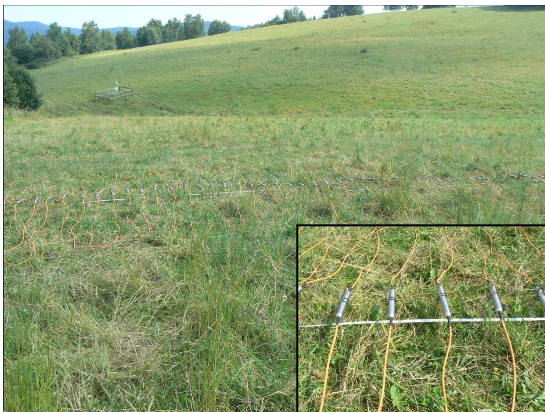
Foto 2 Celkový pohled na proměřovaný transekt T3b. V detailu část transektu s uzemněnými elektrodami v rozponu 0,2 metrů.
