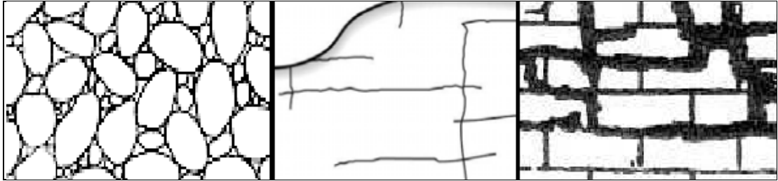
Obr. 2 Schéma horninového prostředí s průlinovou (pórovou), puklinovou a krasovou propustností. Zdroj: (BLÁHA A KOL., 2010).
