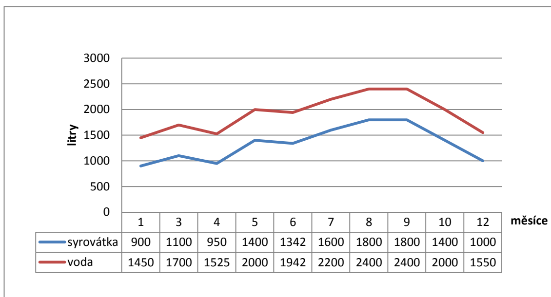
Graf č. 2: Průběh množství odtažené syrovátky a použité prací vody v průběhu jednotlivých měsíců
