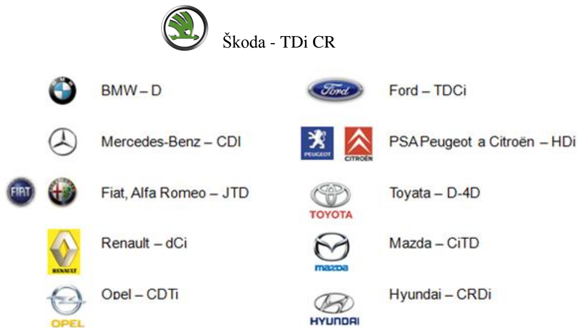
Obr. č. 1 Označení systému Common-Rail výrobci. Zdroj: Prezentace- Robert Bosch odbytová s.r.o. a Škoda auto a.s., Vznětový motor 2,0 l/125 kW TDI CR.
