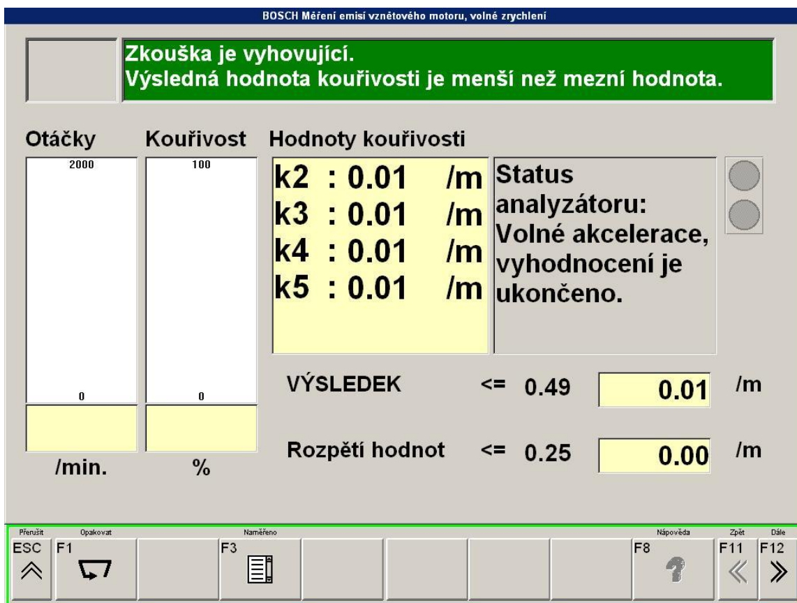
Obr. č. 35 Výsledky měření emisí. Zdroj: ESI-TRONIC (2011)
