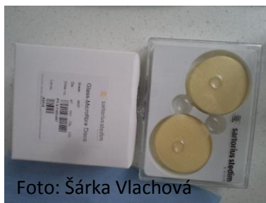
Obrázek č. 36: Filtry použité při jednotlivých fázích filtrace řazeno z leva od 1. filtrace.
