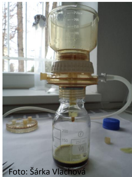
Obrázek č. 34: Výluh po 24 hodinách třepání. Obrázek č. 35: Filtrační aparatura pro 1. fázi filtrace.
