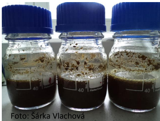
Obrázek č. 34: Výluh po 24 hodinách třepání. Obrázek č. 35: Filtrační aparatura pro 1. fázi filtrace.
