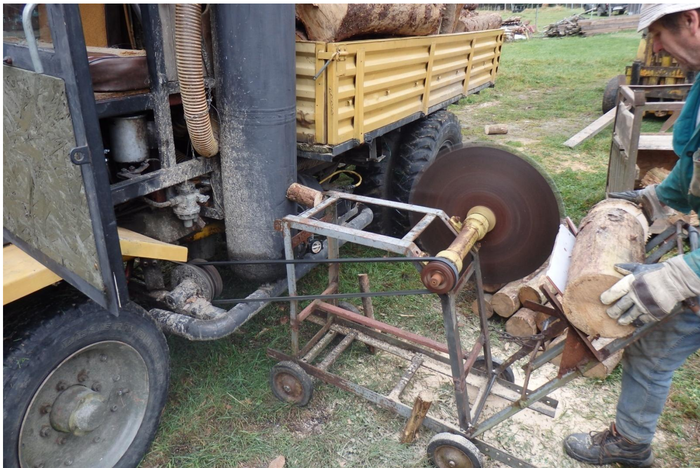
Příloha č. 16 Kotoučová pila připojená k měřenému stroji (autor)
