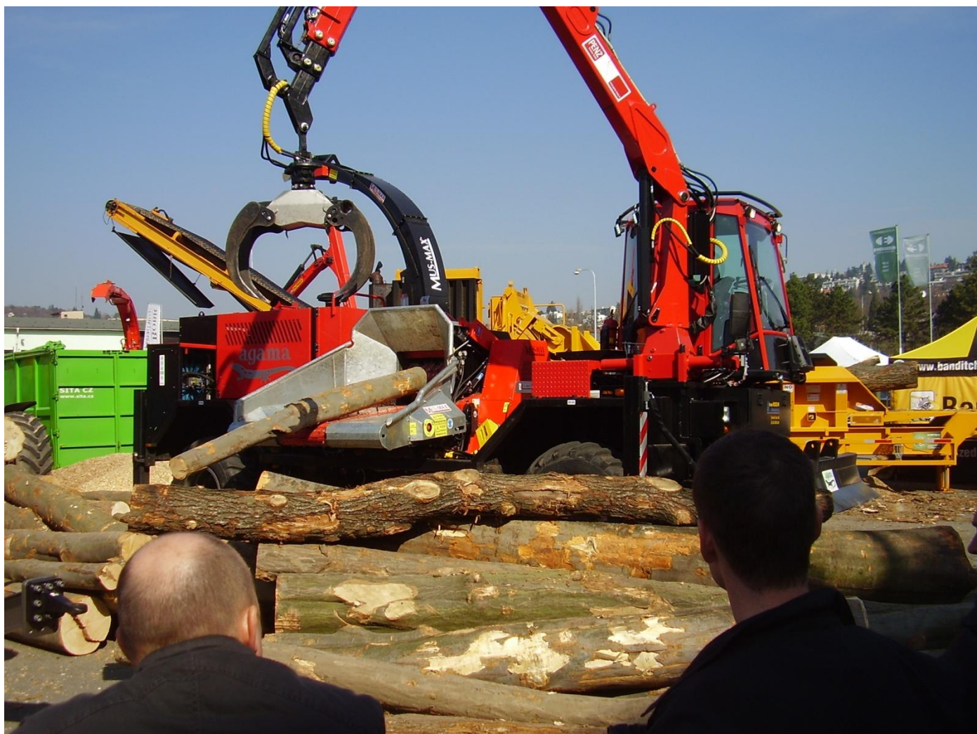
Příloha č. 7 Mechanizované vkládání materiálu do štěpkovače. (autor)
