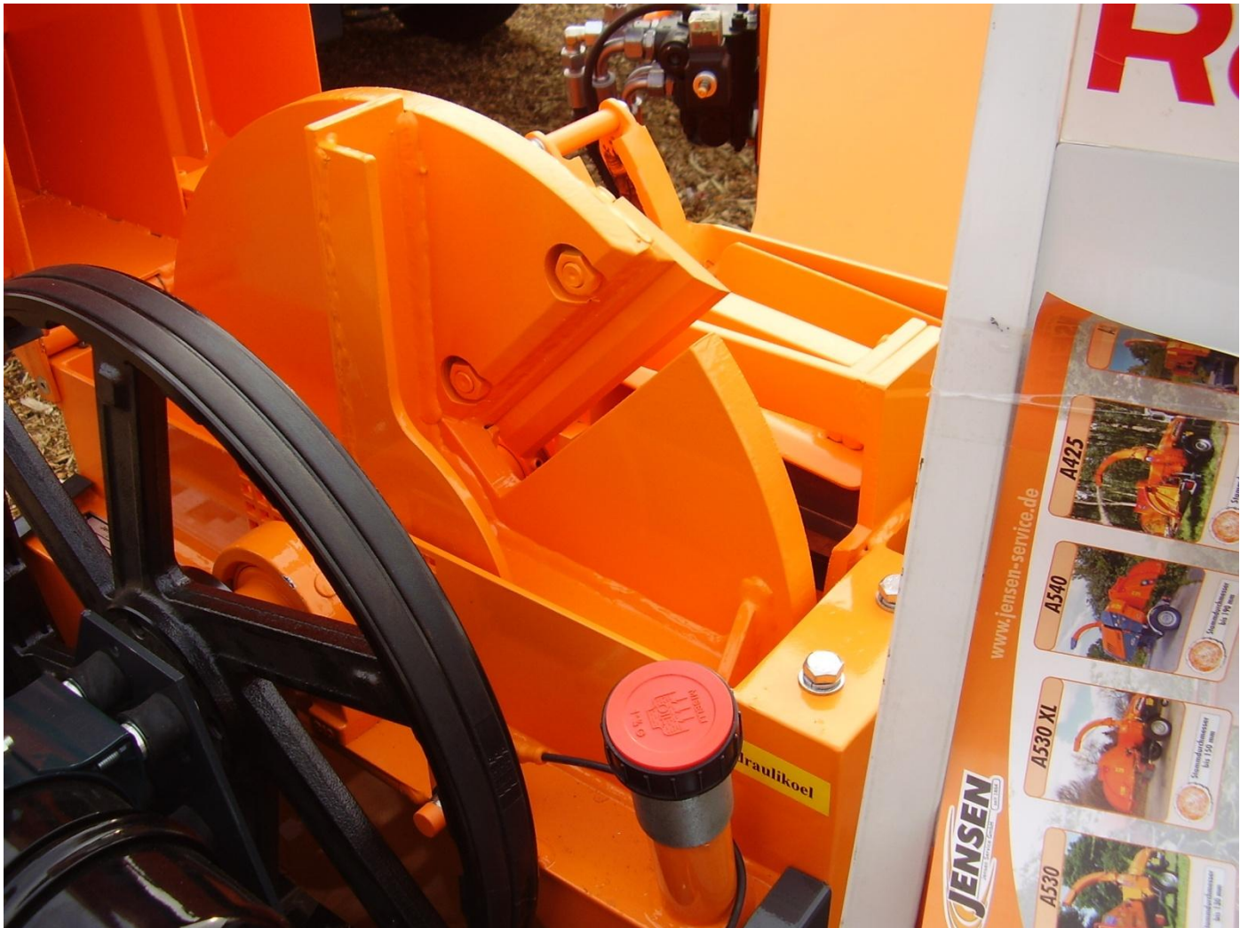
Příloha č. 8 Diskový štěpkovač – uchycení nože (autor)
