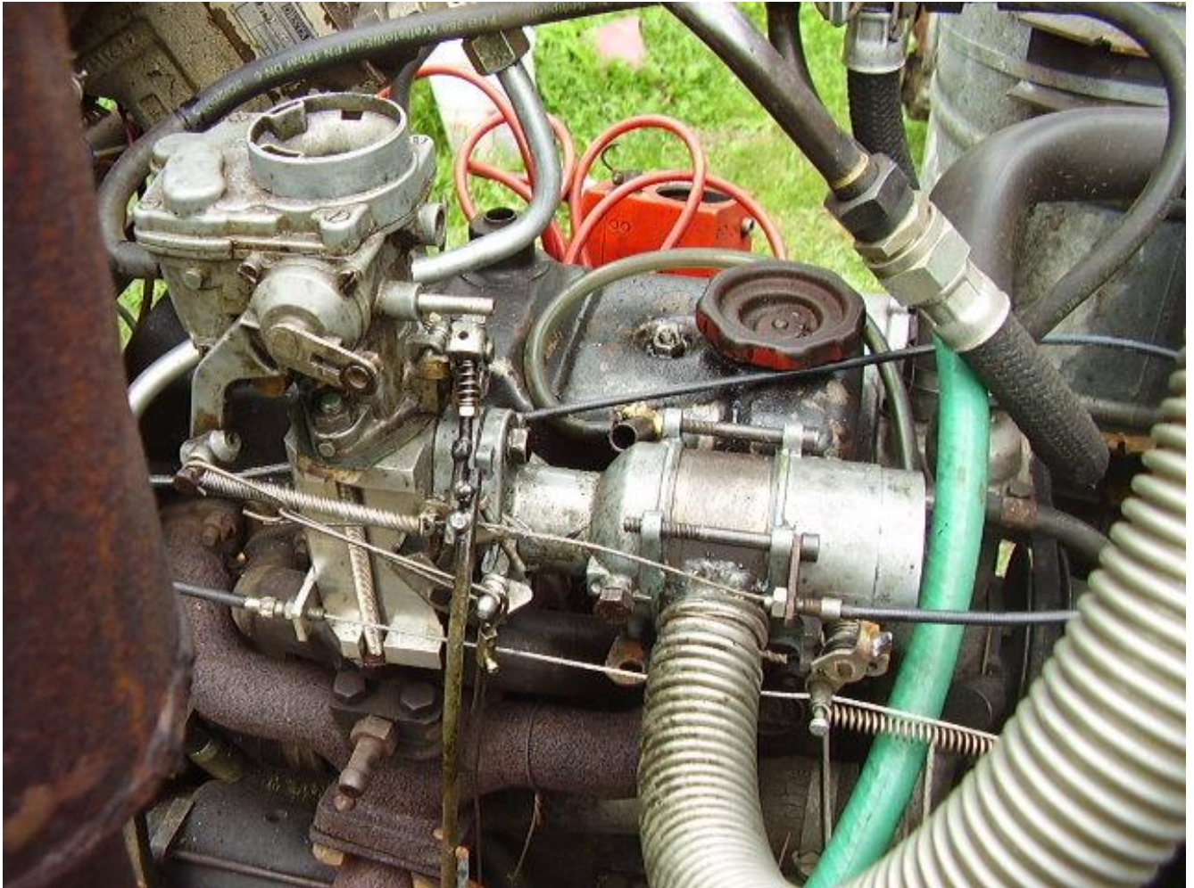
Příloha č. 5. Jednoduchý směšovač v kombinaci s klasickým karburátorem (autor)
