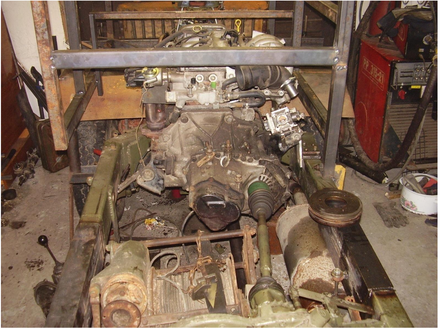
Příloha č. 19 Montáž motoru Mazda 626 (autor)
