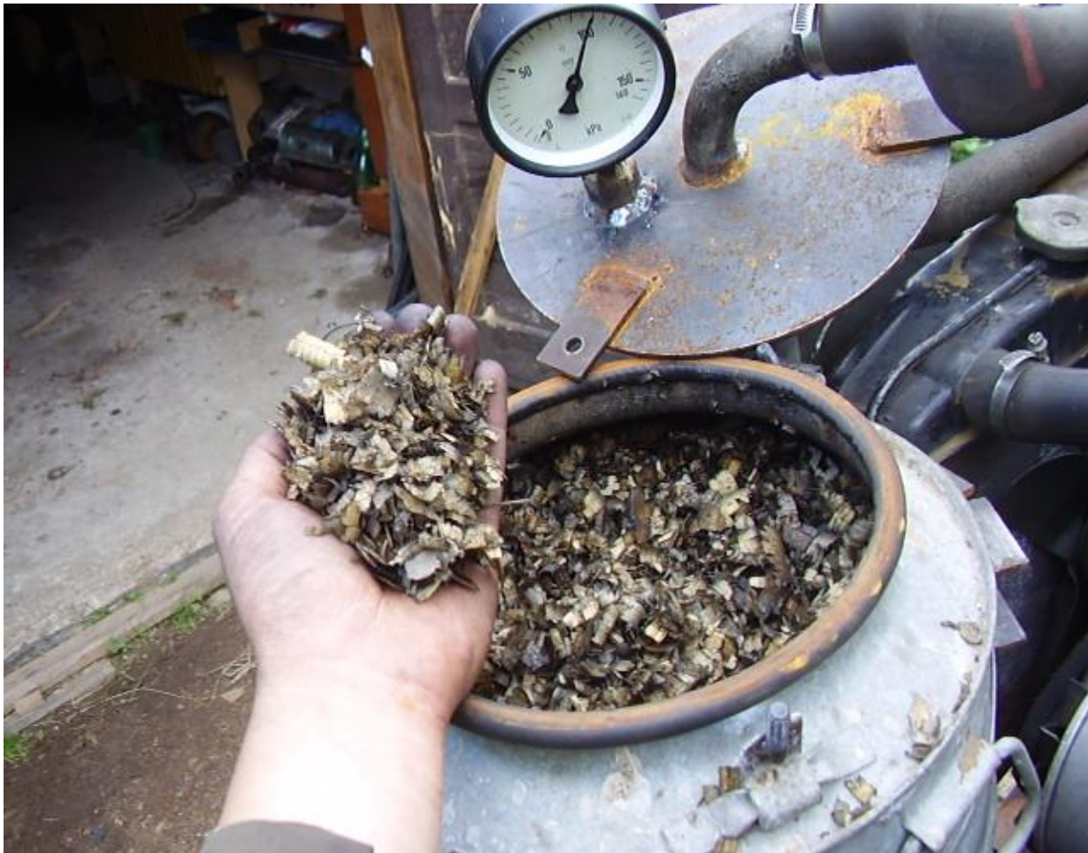
Příloha č. 2. Filtrace dřevoplynu na vrstvě rostlinného materiálu – stav filtračního materiálu po patnácti hodinách provozu. (autor)
