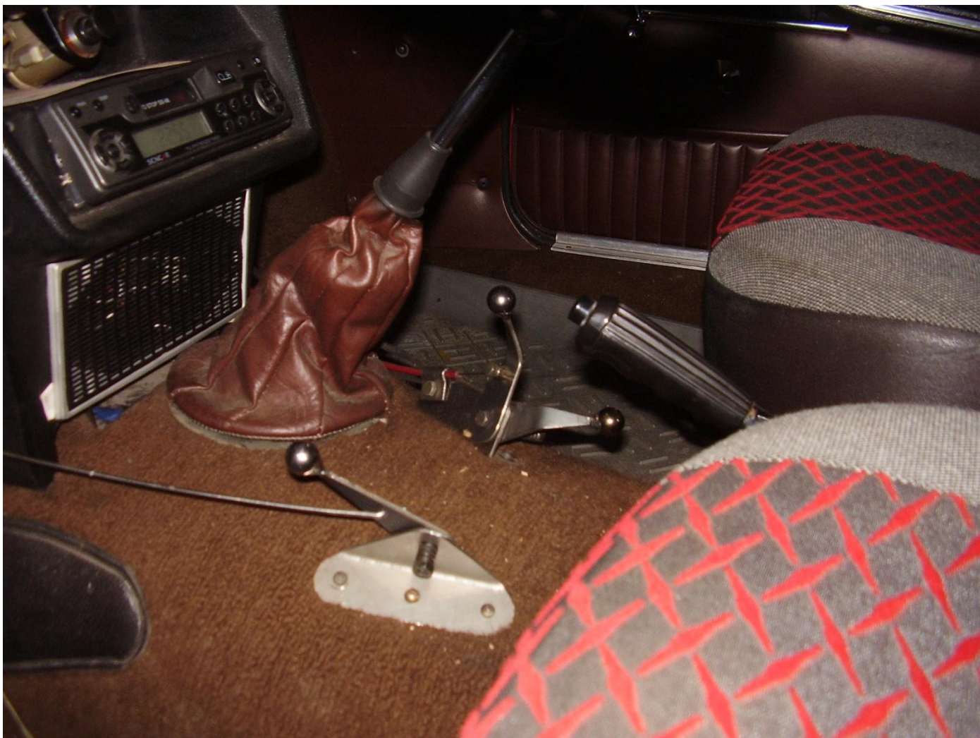
Příloha č. 27 Ruční ovládání směšovacího poměru (autor)
