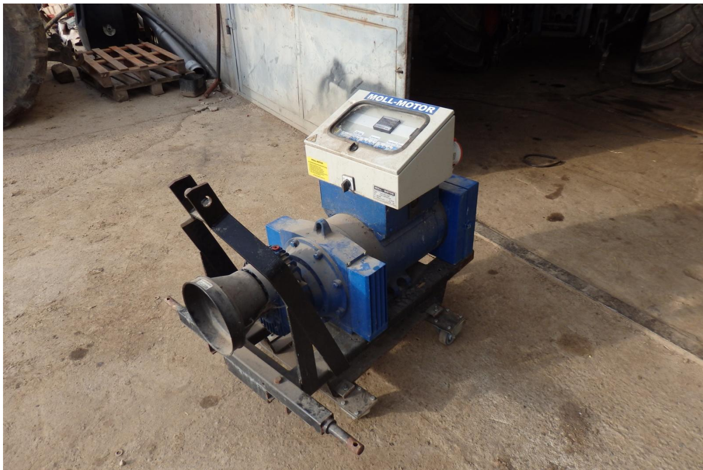
Příloha č. 23 Záložní generátor použitý při měření (autor)
