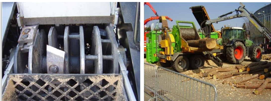
Obrázek 2.16 Pracovní buben štěpkovače a bubnový štěpkovač (foto autor)
