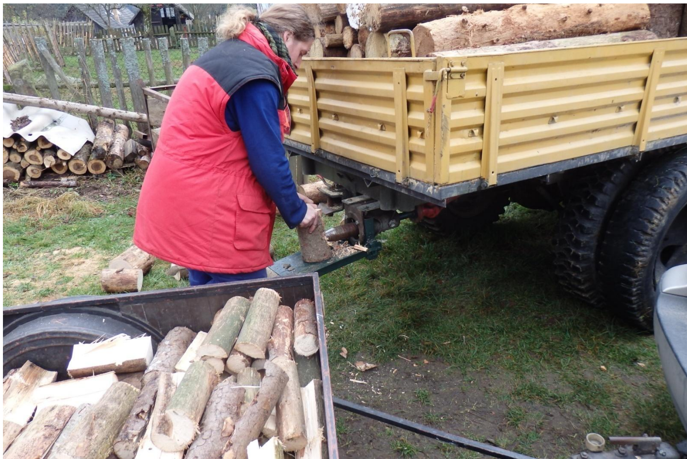
Příloha č. 17 Kuželová štípačka připojená k měřenému stroji (autor)
