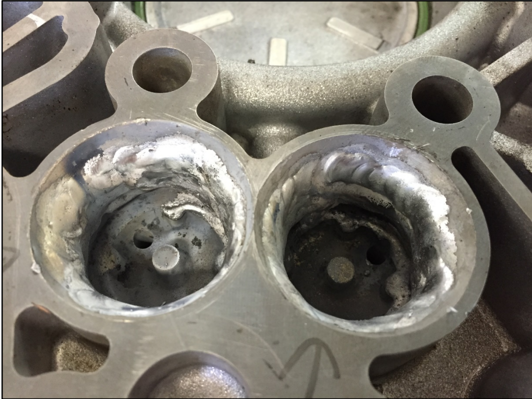
Obrázek 3.8 - Navařená místa poškození
