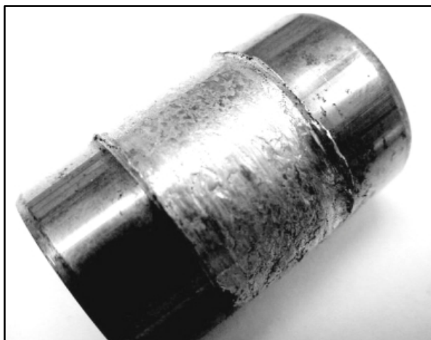
Obrázek 1.2 - Adhezivní opotřebení pístního čepu
