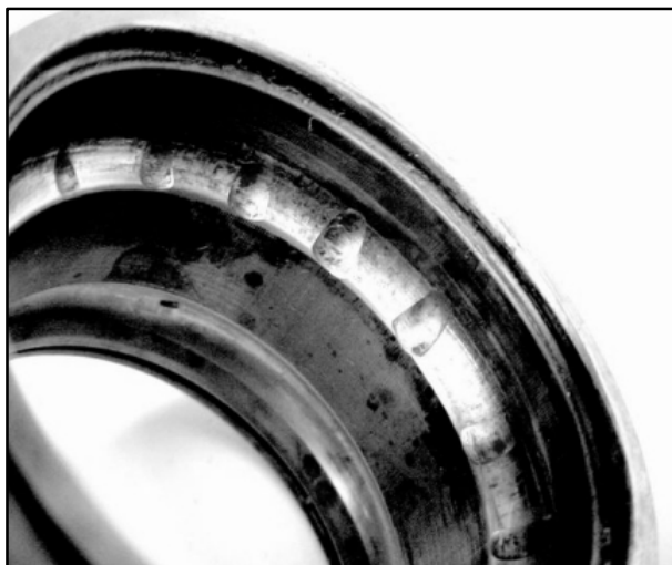
Obrázek 1.7 - Vibrační opotřebení valivého ložiska
