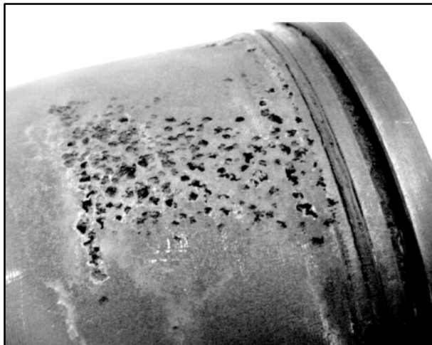
Obrázek 1.5 - Kavitační opotřebení pouzdra válce spalovacího motoru
