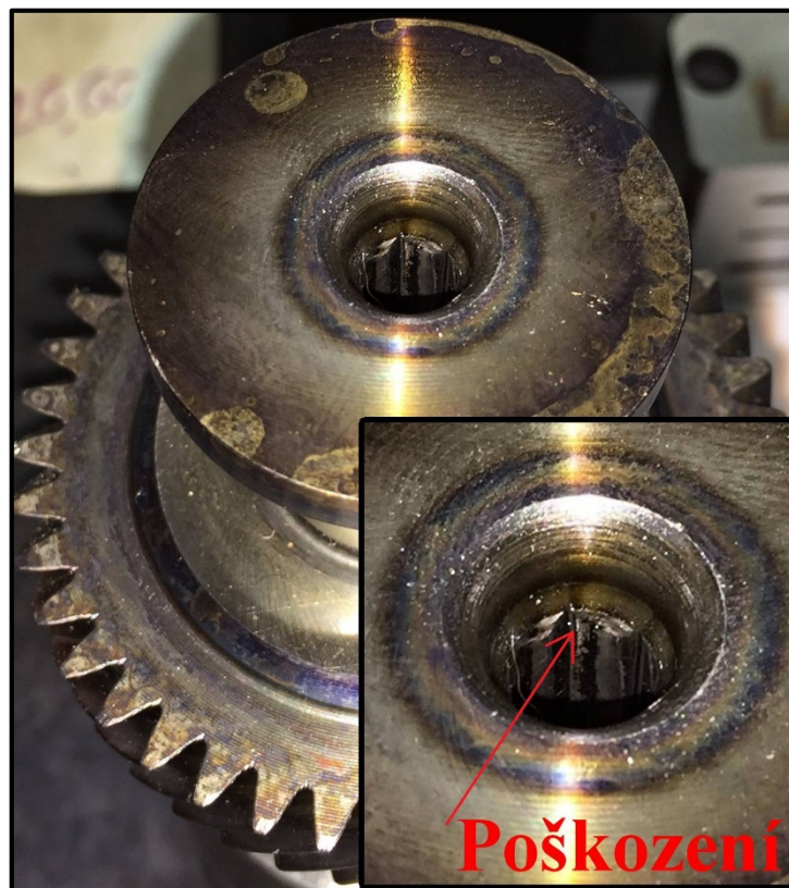
Obrázek 3.1 - Poškození vyvažovací hřídele
