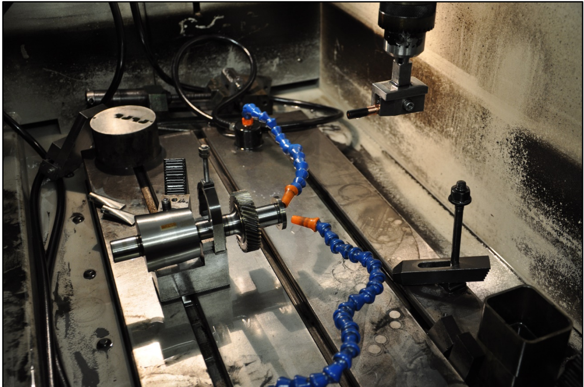
Obrázek 3.4 - Hloubení tvaru do vyvažovací hřídele
