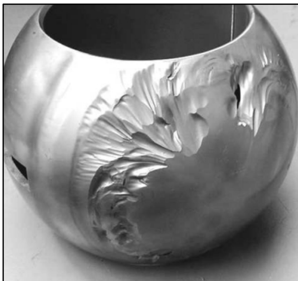
Obrázek 1.4 - Erozivní opotřebení koule uzávěru
