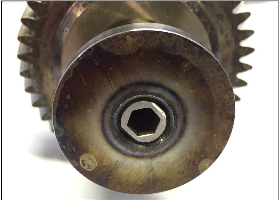
Obrázek 3.5 - Zalepení vložky do hřídele
