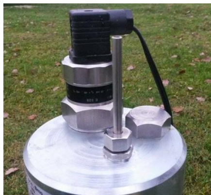
Obr. č. 28 Kapacitní čidlo a úroveň vysunutí zavzdušňovací trubičky (Foto: Jiří Pivoňka)
