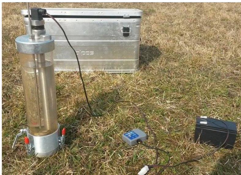
Obr. č. 24 Kompaktní infiltrometr s dataloggerem Omega připojený na 12 V baterii (Foto: Jiří Pivoňka)
