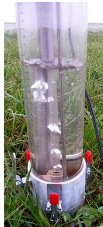
Obr. č. 33 Výron bublin při plnění prostoru pod infiltrometrem (Foto: Jiří Pivoňka)
