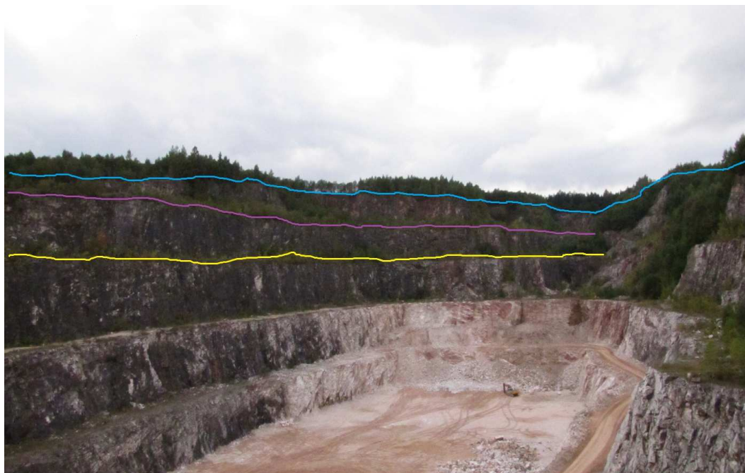
Obr. 4.1.: Znázornění jednotlivých etáží. Mordou barvou je vyznačena etáž 0, růžovou barvou etáž 1 a žlutou barvou etáž 2.
