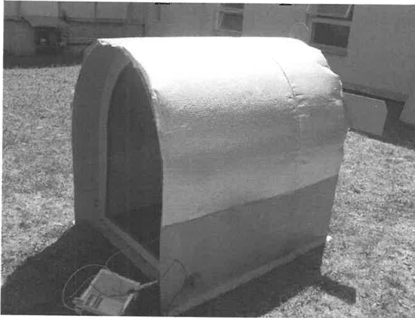
VIB pokryta 50mm vrstvou minerální vaty a AB parozábranou s hliníkovou fólií, varianta 3
