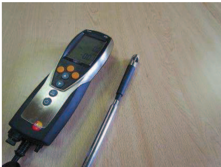
Obr. č. 12 - Příklad Testo 435 s vrtulovou sondou
