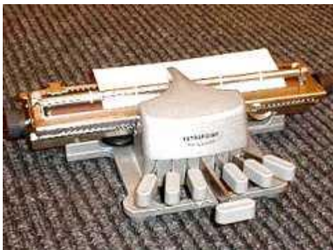
Obr. 1 Pichtův psací stroj pro nevidomé.
