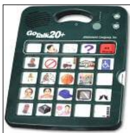
Obr. 7 Go Talk 20 – obsahuje 5 kláves pro klíčové vzkazy a 20 kláves s možností nahrání jednotlivých podúrovní v rozsahu 100 záznamů (1)
