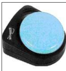
Obr. 6 BIGmack – umožňuje nahrání jednoho vzkazu v délce 75 sekund (1)
