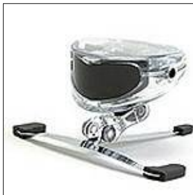
Obr. 13 SmartNAV3 – zařízení, které snímá pohyby hlavy a převádí je do pohybu kurzoru (1)
