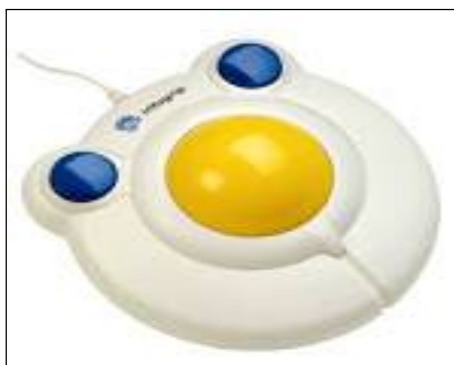
Obr. 14 BIGtrack – kulička ovlivňuje pohyb kurzoru, dvě modrá tlačítka mají stejnou funkci jako levé a pravé tlačítko běžné myši (1)
