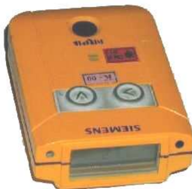
Obr.10 Elektronický osobní dozimetr typu EPD1 firmy Siemens
