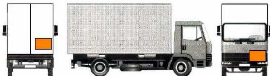
Označení vozidla při přepravě nebezpečných věcí v kusech
