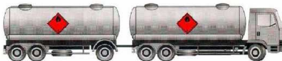
Označení cisternového vozidla s přívěsem výstražnými tabulkami a bezpečnostními značkami při přepravě jedné nebezpečné látky
