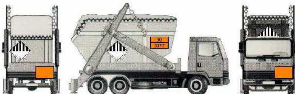
Označení vozidla a kontejneru při přepravě volně ložených tuhých nebezpečných látek
