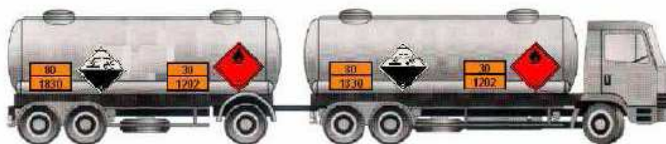
Označení cisternového vozidla s přívěsem výstražnými tabulkami a bezpečnostními značkami při přepravě několika druhů nebezpečných látek
