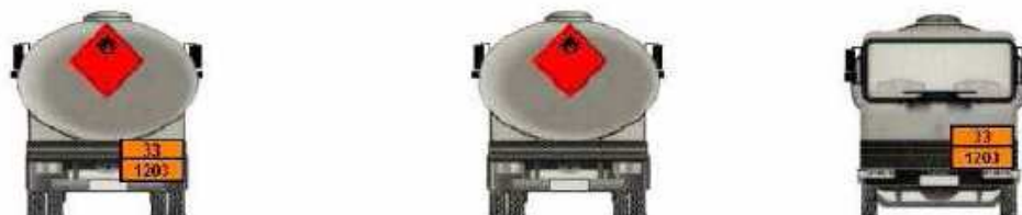
Označení cisternového vozidla s přívěsem výstražnými tabulkami a bezpečnostními značkami při přepravě jedné nebezpečné látky
