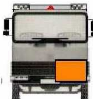
Označení vozidla výstražnými tabulkami a označení kontejneru výstražnými tabulkami a bezpečnostními značkami
