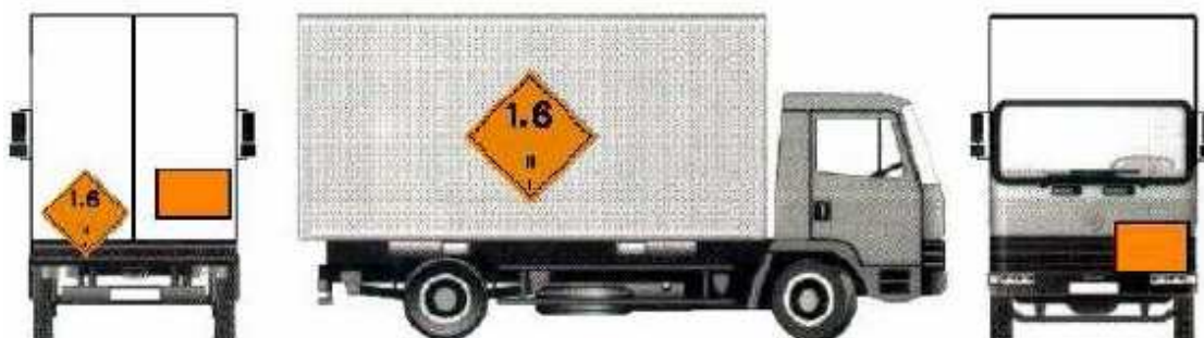
Označení vozidla při přepravě výbušných látek a předmětů
